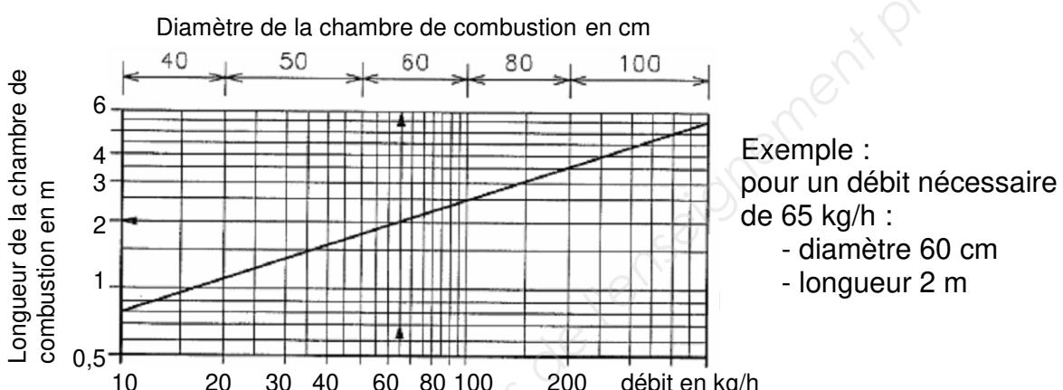
Déterminer les dimensions de la chambre de combustion pour obtenir une puissance thermique égale à 630 kW.
