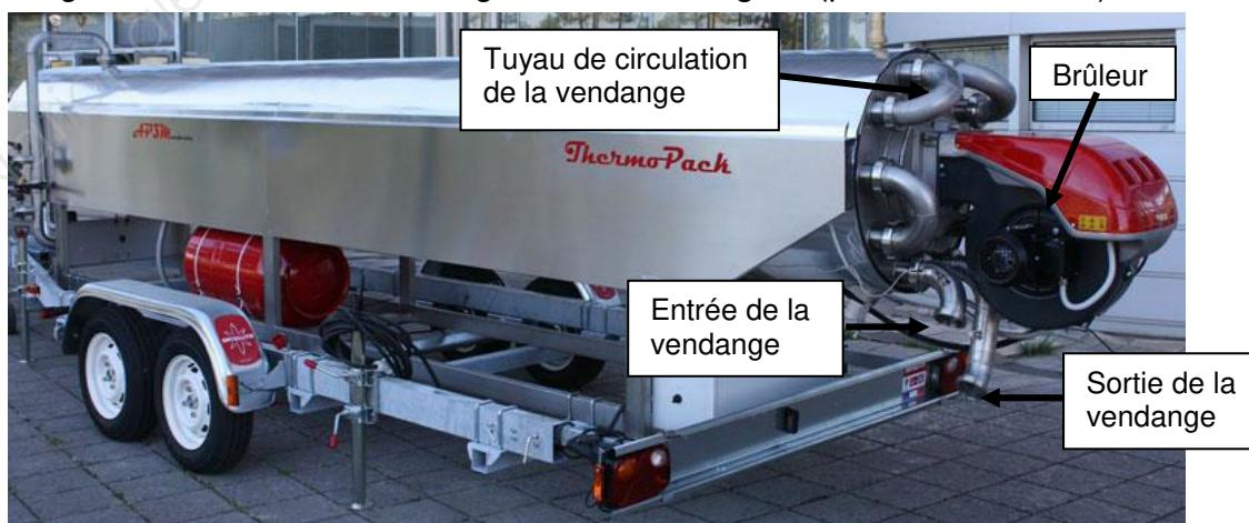
La montée en température du moût, mélange contenu dans la cuve de stockage, est assurée par de l'eau chauffée à l'aide du générateur de chauffe alimenté en fioul (le brûleur).
