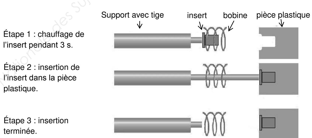
La fréquence de la tension variable alimentant la bobine est égale à 40 kHz.
